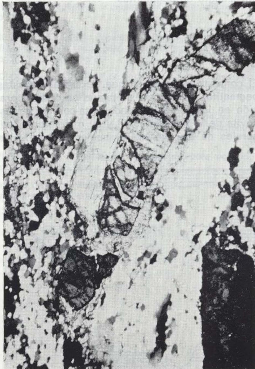
Figura 3.—Cristales de crisoberilo sujetos a deformación. Luz transmitida, sin analizador. Dimensión mayor, 2 cm.
