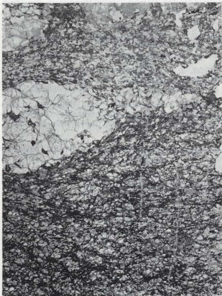
Fotografía 7.—Gneis de La Albarrana. Diferenciados leucosómáticos constituidos por cuarzo y feldespatos, junto con algo de biotita.
