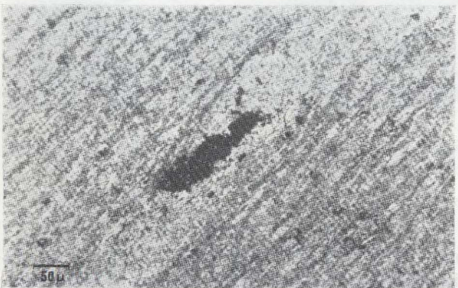
Figura 6.—Aspecto de un cuerpo lenticular que engloba a un resto de foraminífero alterado. (M. L. T. nícoles //).
